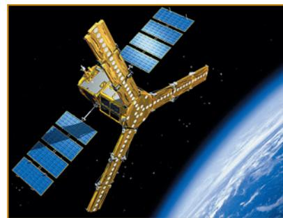
Специализированные спутники, находящиеся на негеостационарных орбитах, производят снимки земной поверхности в инфракрасном диапазоне при помощи так называемых радиометров с последующей передачей их на наземную станцию для детального анализа. На основе разности температуры поверхности земли и температуры очага возгорания возможно определить его приблизительное местоположение.
